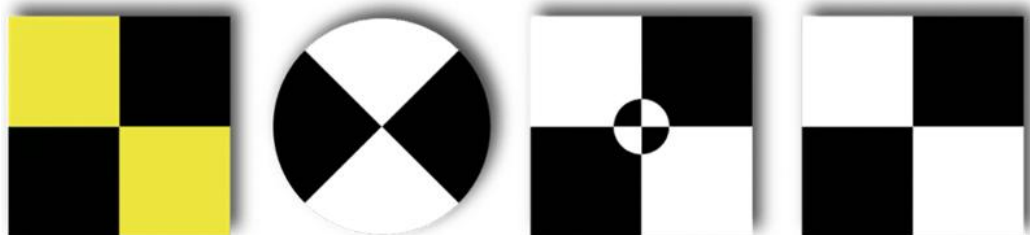
Figura 12 - Exemplo de pontos de controle terrestres (GCPs)
