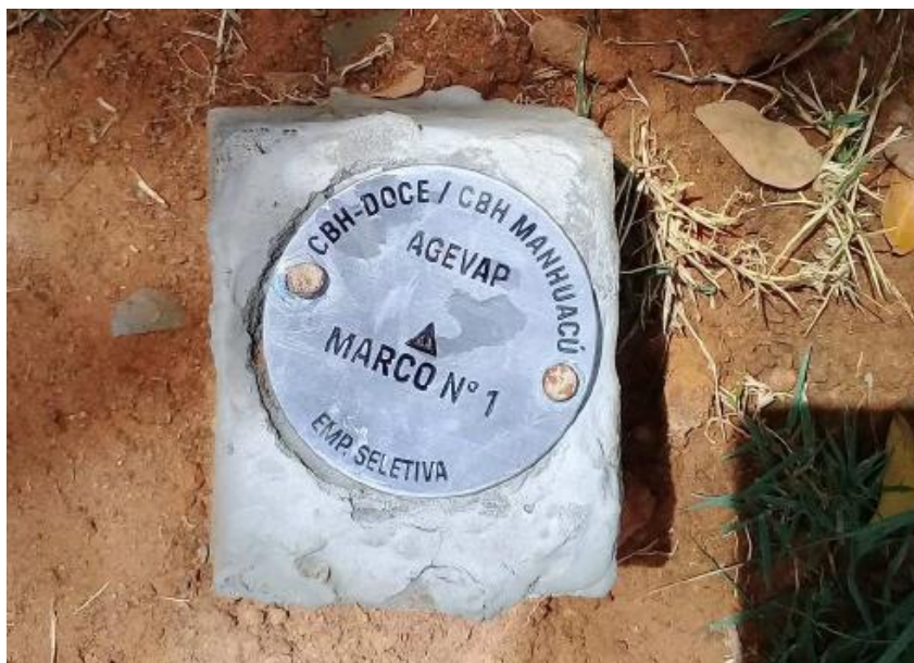
Figura 11 - Exemplo de marco topográfico
