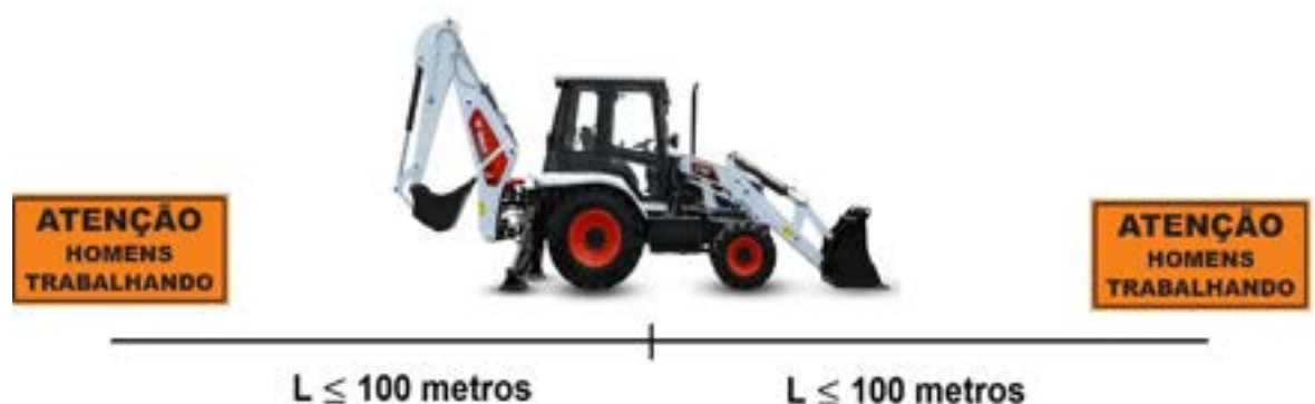
Figura 9 – locação das placas de advertência (sinalização)
