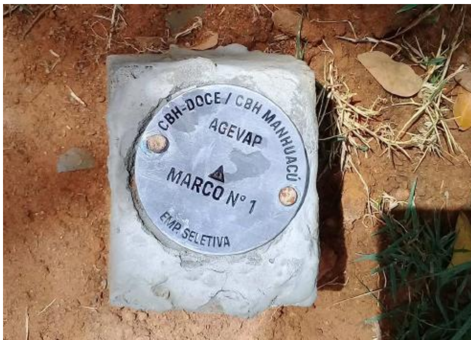
Figura 9 - Exemplo de marco topográfico
